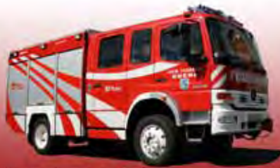
Rüstlöschfahrzeug - RLF-A 2000, Funkname: Rüstlösch Kuchl, MB Atego 1528 AF Allrad, Bj. 2001, Besatzung: 1-3.
