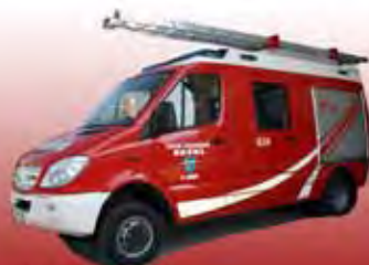
Kleinlöschfahrzeug - KLF-A, Funkname: Pumpe 1 Jadorf, MB Sprinter 518 CDI, Bj. 2010, Besatzung: 1-3.
