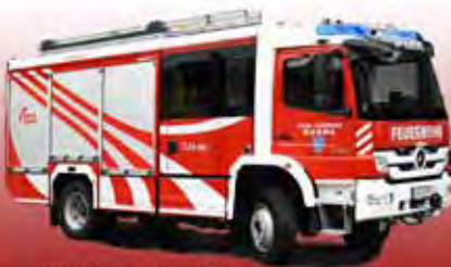
Tanklöschfahrzeug - TLFA 3000, Funkname: Tank Kuchl, MB 1729 AF, Bj. 2017, Besatzung: 1-3.
